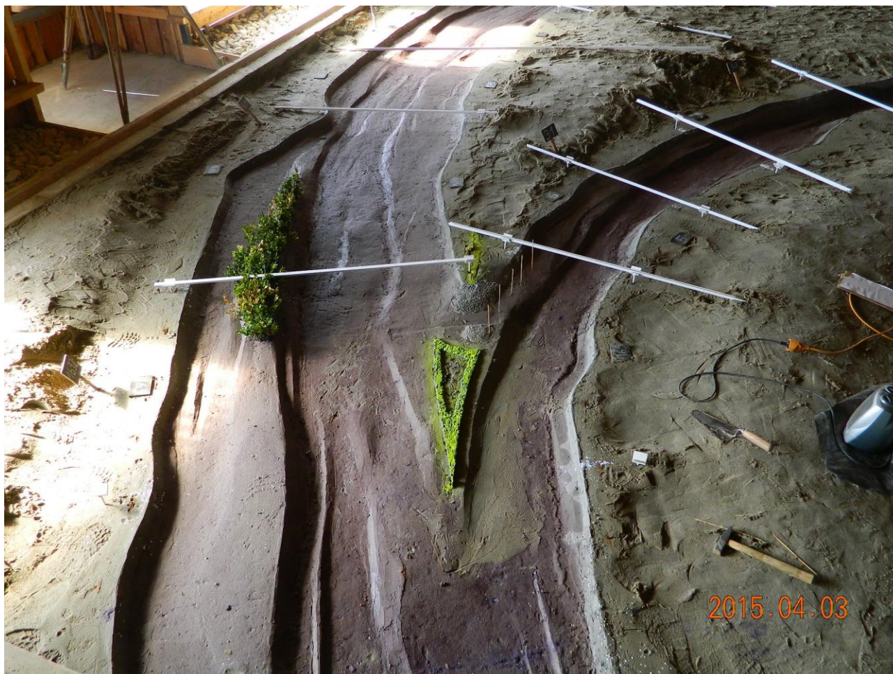
3-2. ábra - A tervezett osztómű beépítése a fizikai modellbe
